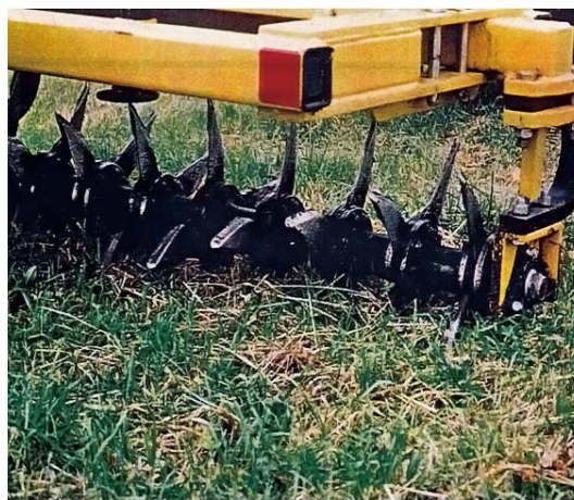
エアレーターで土壌表面を傷つける
