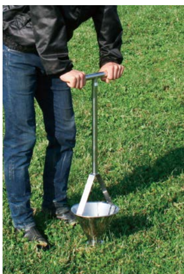
採土器を使ったサンプリング (維持管理用連続式採土器)
