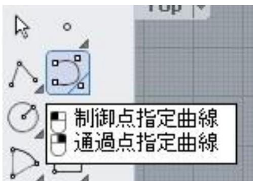
「**制御点指定曲線**」等を使用し、**Topビュー**で張り出した形状を3Dビューに重なるように描きます。
