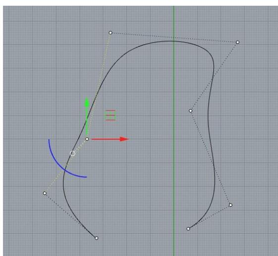
制御点を移動させると、左図のように曲線が制御点に引っ張られる形で変形します。
